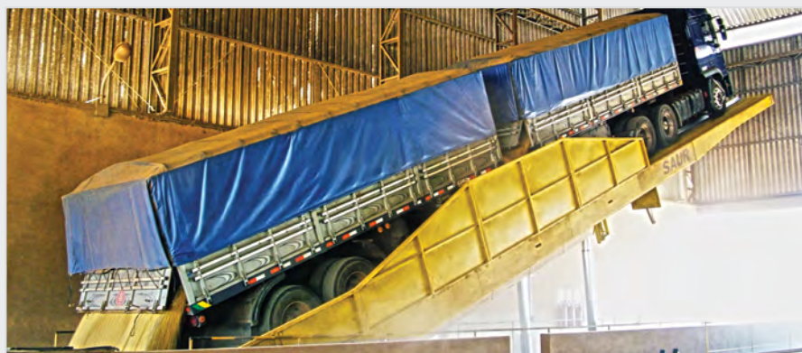
Plataforma de Descarga para Grãos - Tombador
