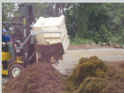
Retenedor de Bins Fixado aos Garfos com Regulagem Manual de Altura.
