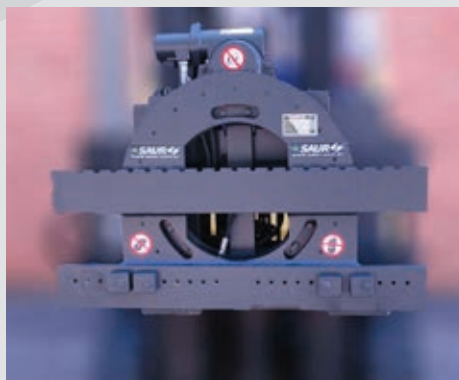
Modelo vazado, permite melhor visibilidade.
