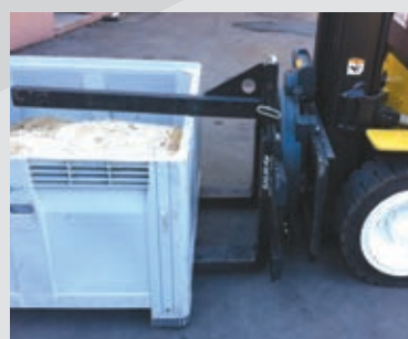
Retenedor de Bins com Articulação Lateral Mecânica.
