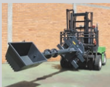
Assume, também a função de alimentador de fornos, através do acoplamento de haste com caçamba.
