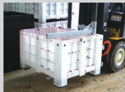
Retenedor de Bins Fixado aos Garfos com Regulagem Manual de Altura.
