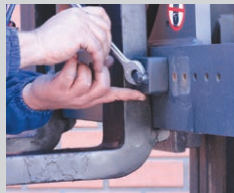
Travamento/fixação dos garfos em diversas posições.
