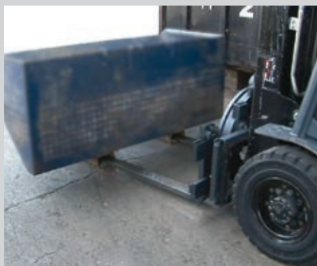
As caçambas necessitam de entrada para os garfos.
