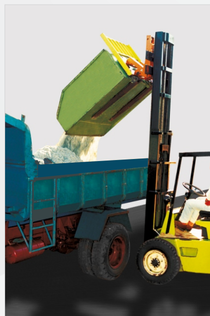
Para volcar frontalmente cargas dispuestas en cucharas o pallets.
