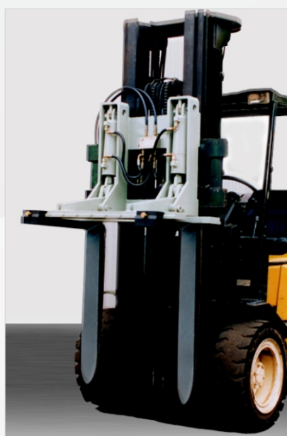
Basculación de las horquillas en 90°.
