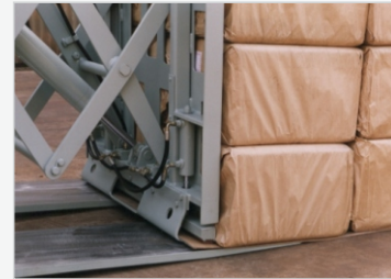
La pinza prende un ala del slipsheet que está saliente de la carga.
