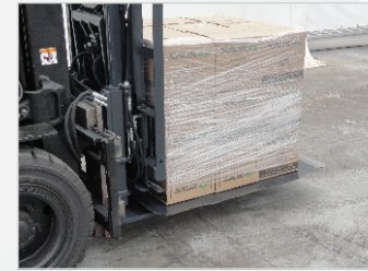
Después, se acciona la palanca para abrir la pinza moderadora. Un indicador visual indica que la pinza está elevada.
