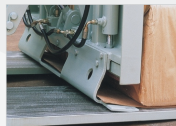
Para depositar, la pinza se abre soltando el slipsheet y el Push-Pull empuja la carga en la medida que la montacargas retrocede.
