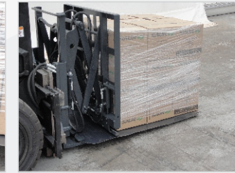
Luego, se baja el conjunto recuperador que prende el slipsheet sobre las horquillas.
