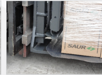
El conjunto recuperador eleva todo el sistema pantográfico, haciendo que el ala del slipsheet salga de la pinza moderadora.
