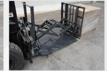
Para finalizar, el Push-Pull empuja la carga en sincronismo con el retroceso la montacargas, y el slipsheet sigue en la empresa para reutilizarlo.
