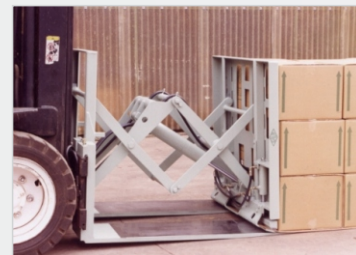
Con el respectivo retroceso de la placa y avance de la montacargas, se introducen las horquillas anchas y finas bajo la carga.
