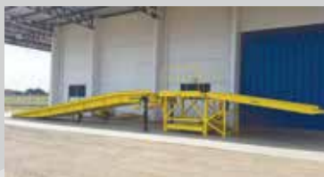
Rampa Rebocável com Patamar e Niveladora.
