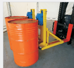
Suspende o tambor pelo anel superior, com encosto na parte de baixo.
