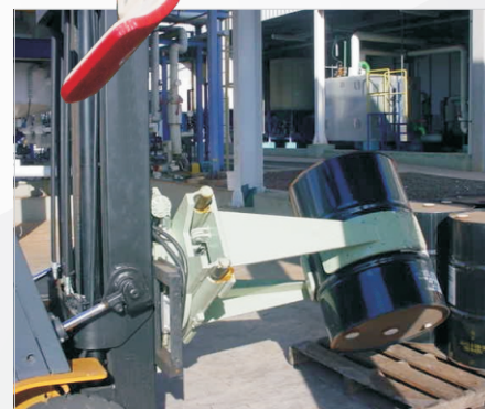
Opción de otra función hidráulica, haciendo que la pinza sea capaz de girar y volcar el contenido del tambor gradualmente.
