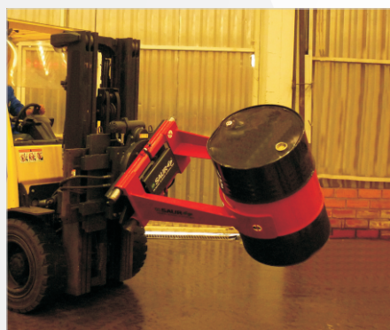
Brazos para uno o dos tambores, con revestimiento interno de caucho que no daña la carga.
