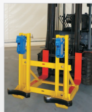
Suspende o tambor pelo anel superior, com encosto na parte de baixo.
