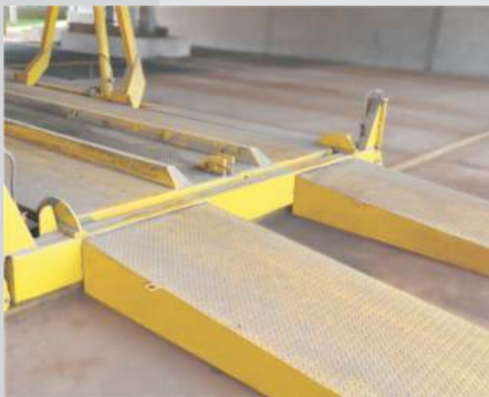
Rampa fechada na saída da Plataforma.
