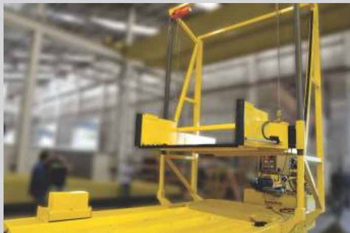
Chapa Auxiliar de Descarga com Talha Elétrica para bitrem desacoplado.
