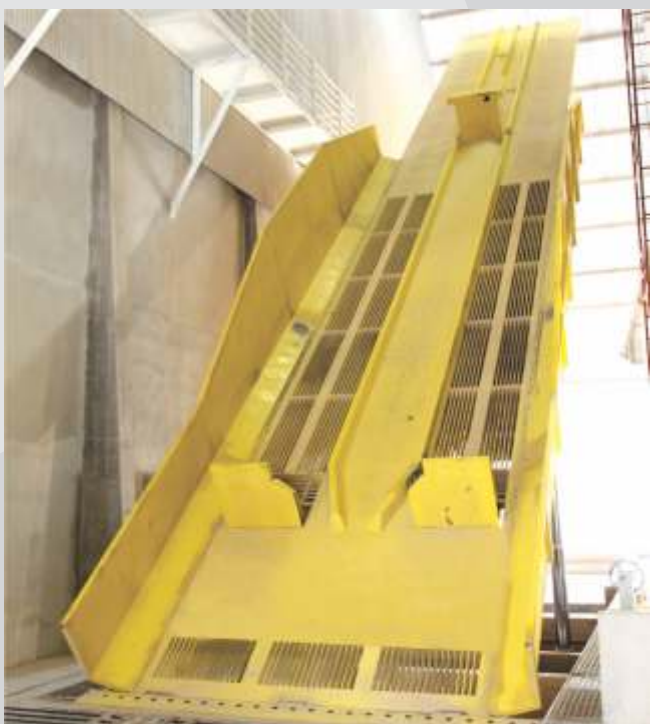
Estrutura tipo sobreposta à moega existente (meia moldura), que também se aplica aos modelos móveis.
