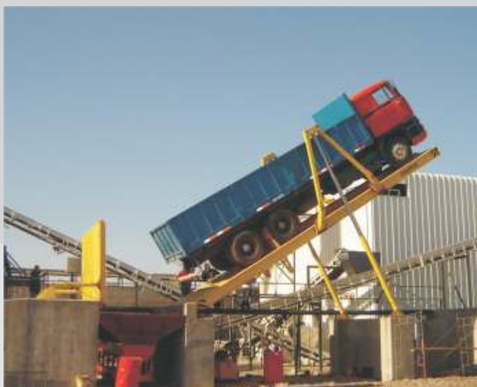
Tampa para moega quando aplicada na descarga de cavacos de madeira, café, mandioca, frutas, minérios, milho em espiga, etc.
