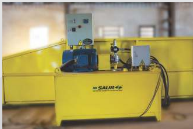
Unidade Hidráulica da Plataforma de Descarga.
