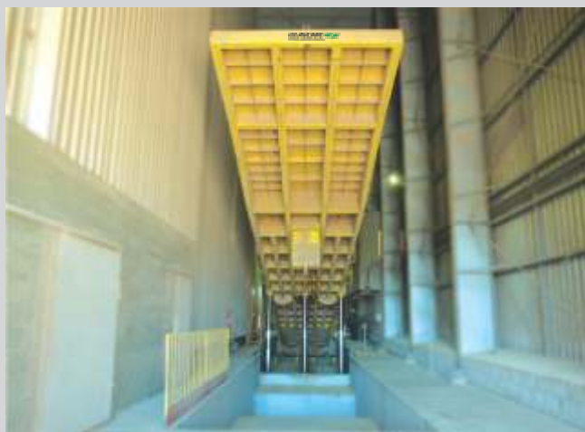
Para modelos com capacidade acima de 90 toneladas, utilizam-se 3 cilindros internos.
