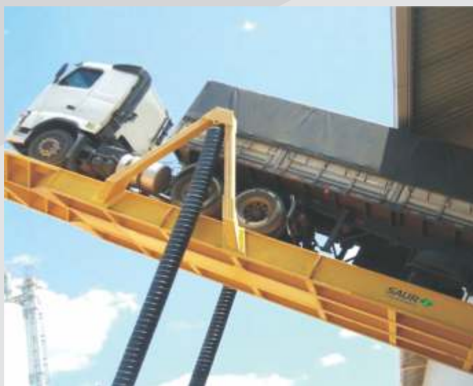
Sistema de proteção com cobertura sanfonada para cilindros de elevação em ambientes com descarga de produtos agressivos ou corrosivos.
