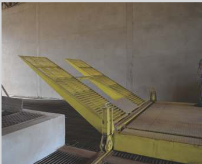
Rampa metálica grelhada (fixa ou retrátil): para ser instalada na entrada da Plataforma.
