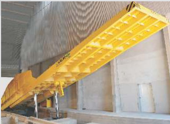
Estrutura tipo embutido no piso, com cilindros internos (sob a plataforma). Construção mecânica com perfil “U” (viga caixão).
