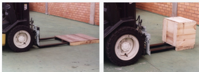
Posicionamiento Hidráulico de las Horquillas
