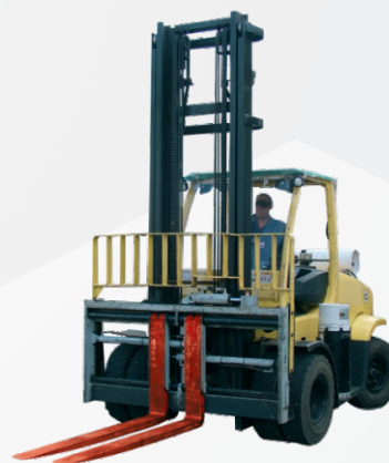
Posicionamiento Hidráulico de las Horquillas
