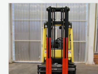
Movimiento de las cuatro horquillas sólo con un mando. Acerca las horquillas externas a las internas para cargar un pallet.
