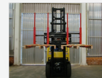
Aleja los 2 pallets, permitiendo visibilidad al operador. Horquillas con protector de carga incorporado.
