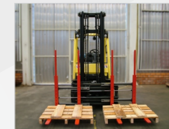
Transporte de pallets con reducción de tiempo y menor desgaste de la montacargas.
