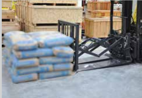
O carregamento é conforme o Push Pull convencional.
