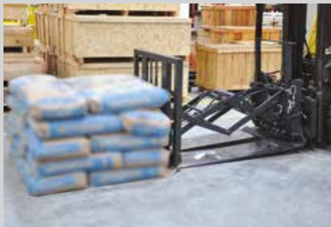
O carregamento é conforme o Push Pull convencional.
