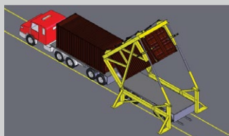
6 - Encerrado o carregamento, as portas são fechadas hidraulicamente.
