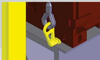
9 - Deposita-se o contêiner sobre o caminhão desengatando os cabos.
