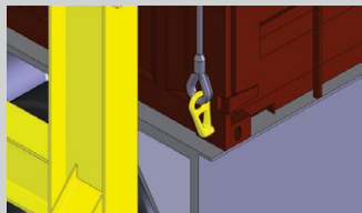
2 - Engata-se manualmente os cabos de aço no contêiner com ganchos especiais. Após, abre-se as portas manualmente.
