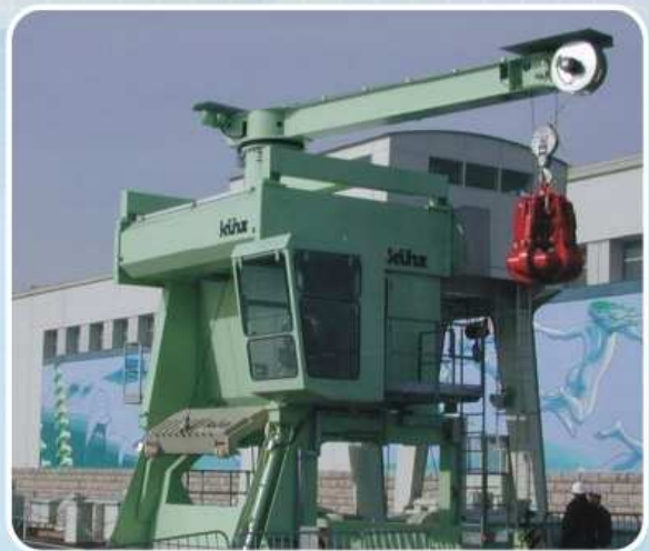
Cabines de operação climatizadas
