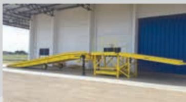
Rampa Rebocável com Patamar e Niveladora.
