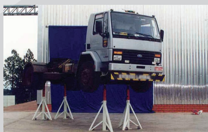
Cavelete grande de apoio: 1.220 a 2.110 mm de altura.
