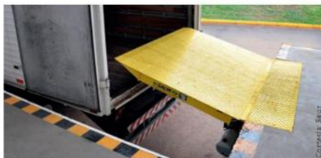
Plataforma niveladora avançada
