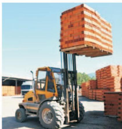
O Posicionador Duplo de Garfos produzido pela Saur está sendo utilizado para movimentar cargas de tijolos.
