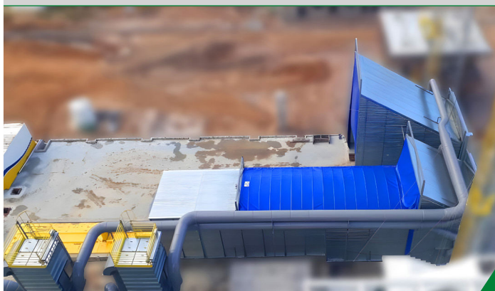
Telhado Retrátil. Permite descarga de caçambas
