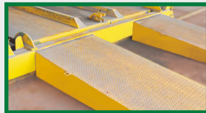
Chapa Auxiliar de Descarga com Talha Elétrica para bitrem desacoplado.
