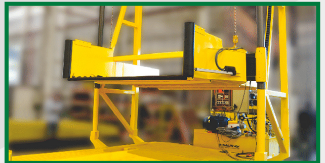
Chapa Auxiliar de Descarga com Talha Elétrica para bitrem desacoplado.
