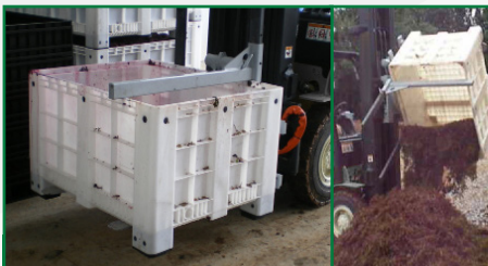
Modelo de Retentor de Bins Fixo preso em um dos garfos.
