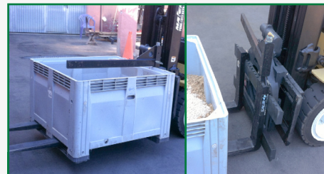
Retentor Manual de Bins com Retenção Articulada Lateral: deixa os garfos livres para movimentar outras cargas.
