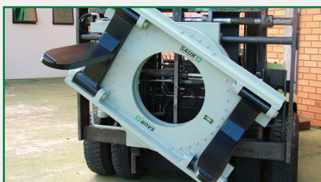
Modelo com Garfos centralizados para Cadinhos.
