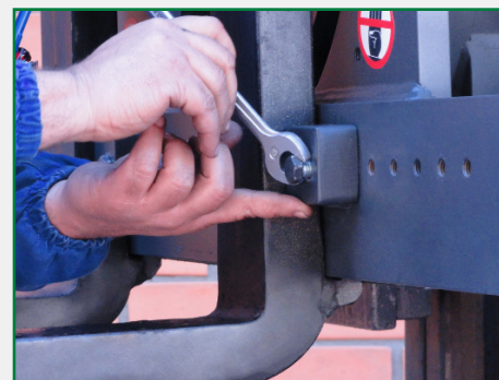
Travamento/fixação dos garfos em diversas posições.
