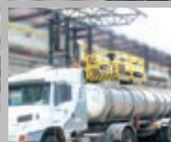
Torre Elevadora para acessar o bocalde inspeção de caminhões tanque.
