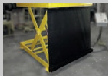
Dispositivo de segurança no perímetro externo, evitam o efeito guilhotina, impedindo o acesso e interrompendo o movimento de descida ao encontrar qualquer obstáculo.
