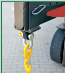
Gancho móvel de fácil ajuste ao longo da viga, travado manualmente
