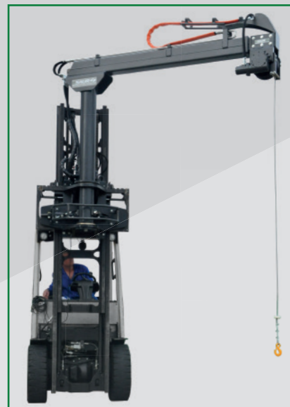
Lança Guindaste Giratória: é instalada no portagarfos da máquina e possui movimentos de giro e telescopia mecânicos ou hidráulicos.
