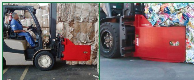
Garra para Recicláveis com braço reforçado e com chapa de desgaste na parte inferior e chapa de proteção para os cilindros.
