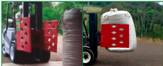
Garra Hidráulica para movimentar big bags de erva-mate.
