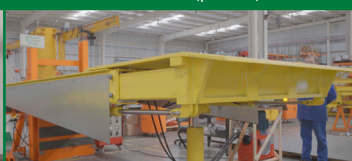
Opcional do equipamento: Pestana com avanço Telescópico.
