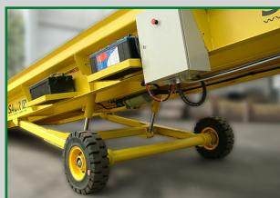
**Manual:** A elevação e o nivelamento manual de 1.300 a 1.750 mm com duas velocidades.
