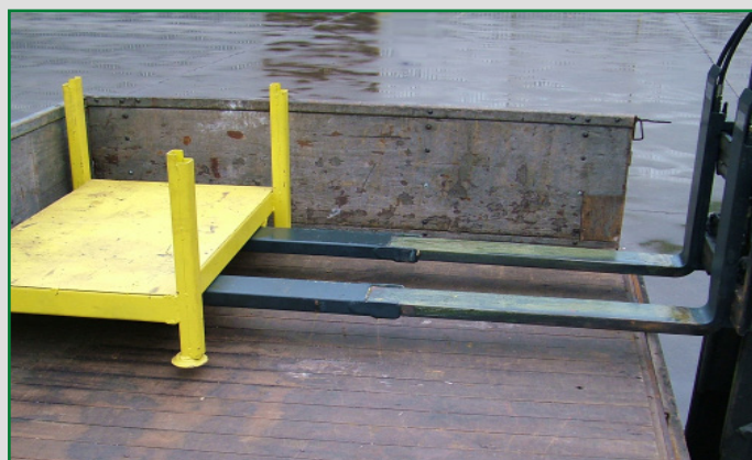
Combinam a agilidade dos Garfos Convencionais curtos com a possibilidade de alcançar cargas distantes, como na extremidade oposta do caminhão ou prateleira de dupla profundidade.
