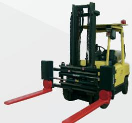
**Observações:** Las capacidades constantes son de las Pinzas. Es necesario tener en cuenta la carga y la Pinza para determinar la capacidad de la montacargas. Dimensiones en milímetros. Para las capacidades indicadas, la presión máxima de trabajo es de 150 kg/cm<sup>2</sup> (2200 psi).
