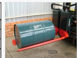
Con giro hidráulico de las horquillas – 02 Funciones Hidráulicas.
