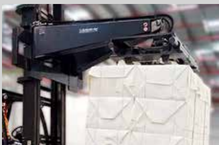
Garra para Suspender Fardos de Celulose pelo Arame
