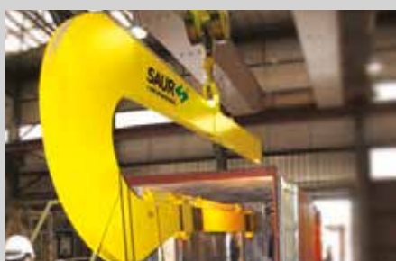
Dispositivo em C para carregar e descarregar caixas de vidro em contêiner
